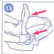
図13) ハンドルラッチ（ハンドルの下にある赤いレバー）を左右同時に押し、ロックを解除してください。
